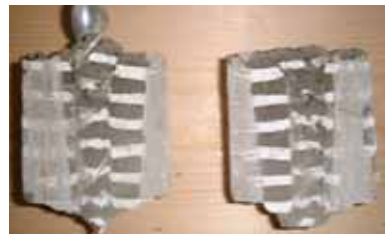
図5.1 せん断破壊後の地盤状況
